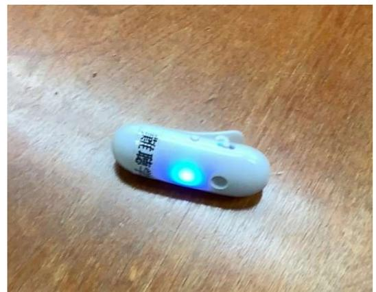
この電子機器は90 dB以上の音、または60 dB以上の音に反応し、音の大きさに応じて光り、振動する機械です。反応する音の大きさの設定は、スイッチで切り替えることができます。現在1台を購入し生徒が使っています。生徒から要望があれば追加で購入をしていきたいと考えています。
